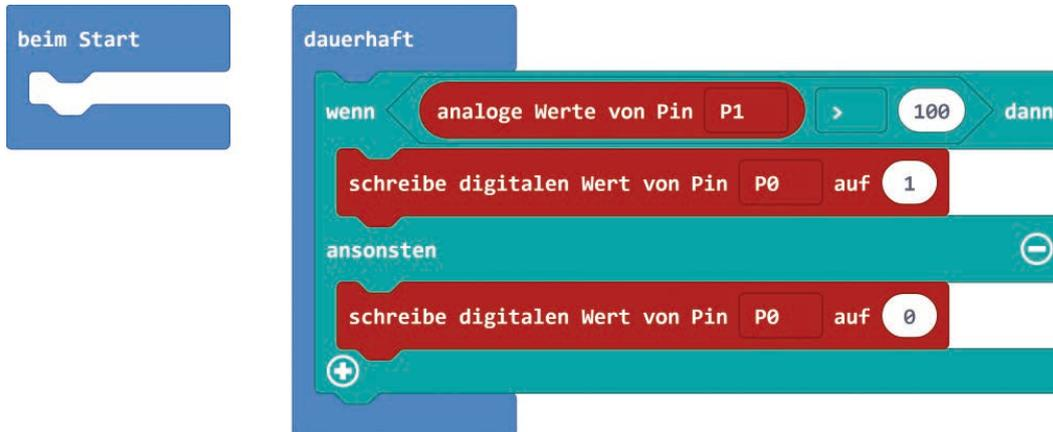
Ein Fototransistor liefert je nach Helligkeit einen analogen Wert zwischen 0 und 1023, der allerdings umso höher ist, je weniger Licht auf den Fototransistor fällt.
